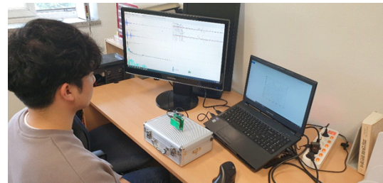
그림 1. 호흡 측정 실험 환경 Fig. 1. Experimental setup for measurement of respiration
