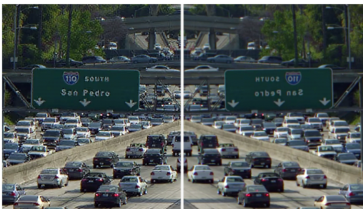
그림 5. 개선결과 예(3) Traffic 부분영상 (A class) (50번 프레임, Qp=22) 좌측은 개선영상(이득(λ)=4), 우측은 원영상 Fig. 5. Enhancement(3) Traffic partial image (A class) (50th frame, QP=22) Left: enhanced image(λ=4), Right:original image
