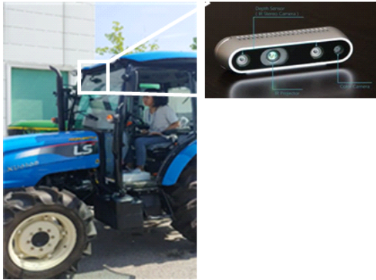
그림 2. 트랙터 상단부에 장착된 카메라 Fig. 2. RGB camera mounted on the front side of a tractor
