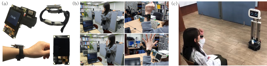
그림 1. 환자를 위한 손동작 인식 디바이스 구현 (a) 구현한 손동작 인식 디바이스 (b) 구현한 디바이스의 실시간 손동작 인식 (c) 구현한 디바이스의 스마트 병원에서의 활용 Fig. 1. Implementation of a wrist band device with hand gesture recognition (a) Implemented device (b) Real-time hand gesture recognition using the device (c) Using the device in smart hospital
