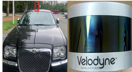
그림 10. 차량 위 라이다 센서의 위치 Fig. 10. Position of the lidar sensor on the vehicle.
