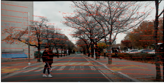
그림 3. 체스보드를 이용한 위치 정합 알고리즘 결과 Fig. 3. Calibration result using chess board.
