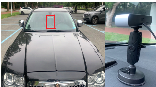
그림 9. 차량 내부의 카메라 센서의 위치 Fig. 9. Position of the camera sensor inside the vehicle.
