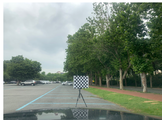
그림 1. 체스보드를 이용한 위치 정합 실험 Fig. 1. Calibration experiment using chess board.
