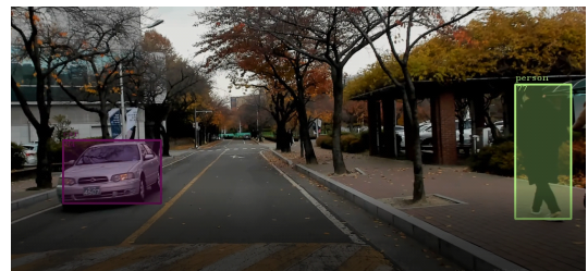
그림 8. 실제 환경에서 적용한 YOLO V4의 결과 Fig. 8. Results of YOLO v4 applied in real environment.
