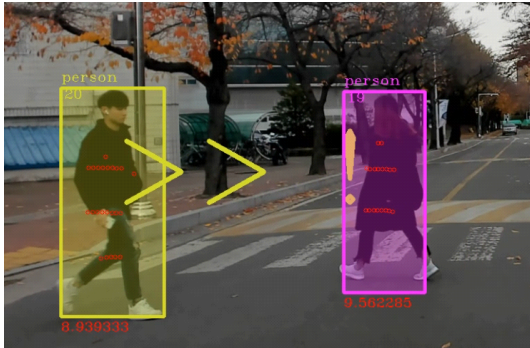
그림 14. ROI기반 위치보정을 실제 환경에서 적용한 결과 Fig. 14. Result of using ROI-based positioning in real environment.
