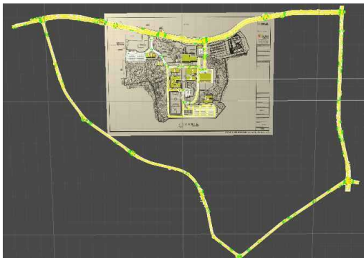
그림 2. 자율주행용 2D 정밀 맵과 정합된 증강현실 실감가이드 서비스용 3차원 공간 맵 Fig. 2. The 3D spatial map for AR immersive guide service matched with 2D detailed map for autonomous driving
