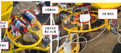
그림 9. 수중구조물 (좌. 센서노드, 우. 수중기지국) Fig. 9. Underwater structure (L. Sensor node, R. Underwater base station)
