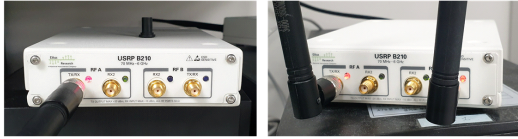
그림 14. 1x2 STLC를 위한 USRP 안테나 연결 포트 Fig 14. USRP antenna connection port for 1x2 STLC.
