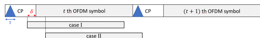
그림 9. STO가 존재할 때, OFDM 시작점에 대한 두 가지 경우 Fig. 9. Two cases of OFDM starting point when STO exists.
