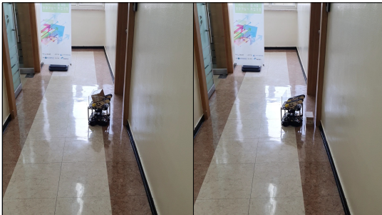
(c) 목적지 도착 및 하역을 위한 차체 회전 (c) Arrived at the target address and rotating the parcel (d) 컨베이어 벨트 구동을 통한 물품 하역 (d) Drop the parcel by operating the conveyor belt
