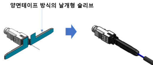
그림 6. 날개형 슬리브 방식의 용착접속 광커넥터 Fig. 6. Winged sleeve type fusion splicing optical connector
