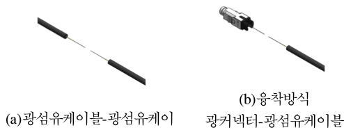
그림 2. 열수축 튜브를 이용한 용착접속기의 현장조립광커넥터 Fig. 2. Field assembly optical connector of fusion splicing method using heat shrink tube
