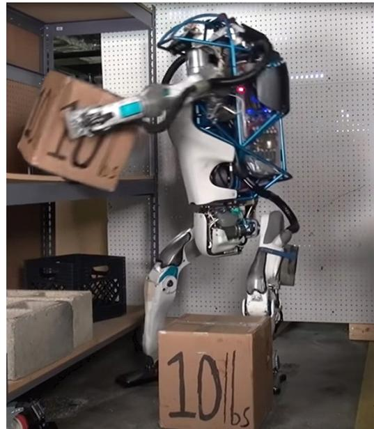
그림 1. 보관대에 박스를 옮기는 ATLAS<sup>TM</sup> 컴퓨팅AI로봇
