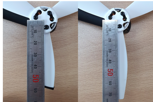
그림 7. 고장 및 정상 드론 구성 Fig. 7. Set up for defect and normal drone
